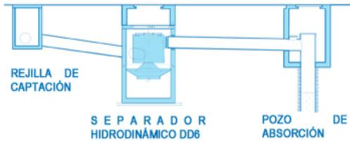
Esquema en corte de emplazamiento de pozo de anSORCIÓN #5
